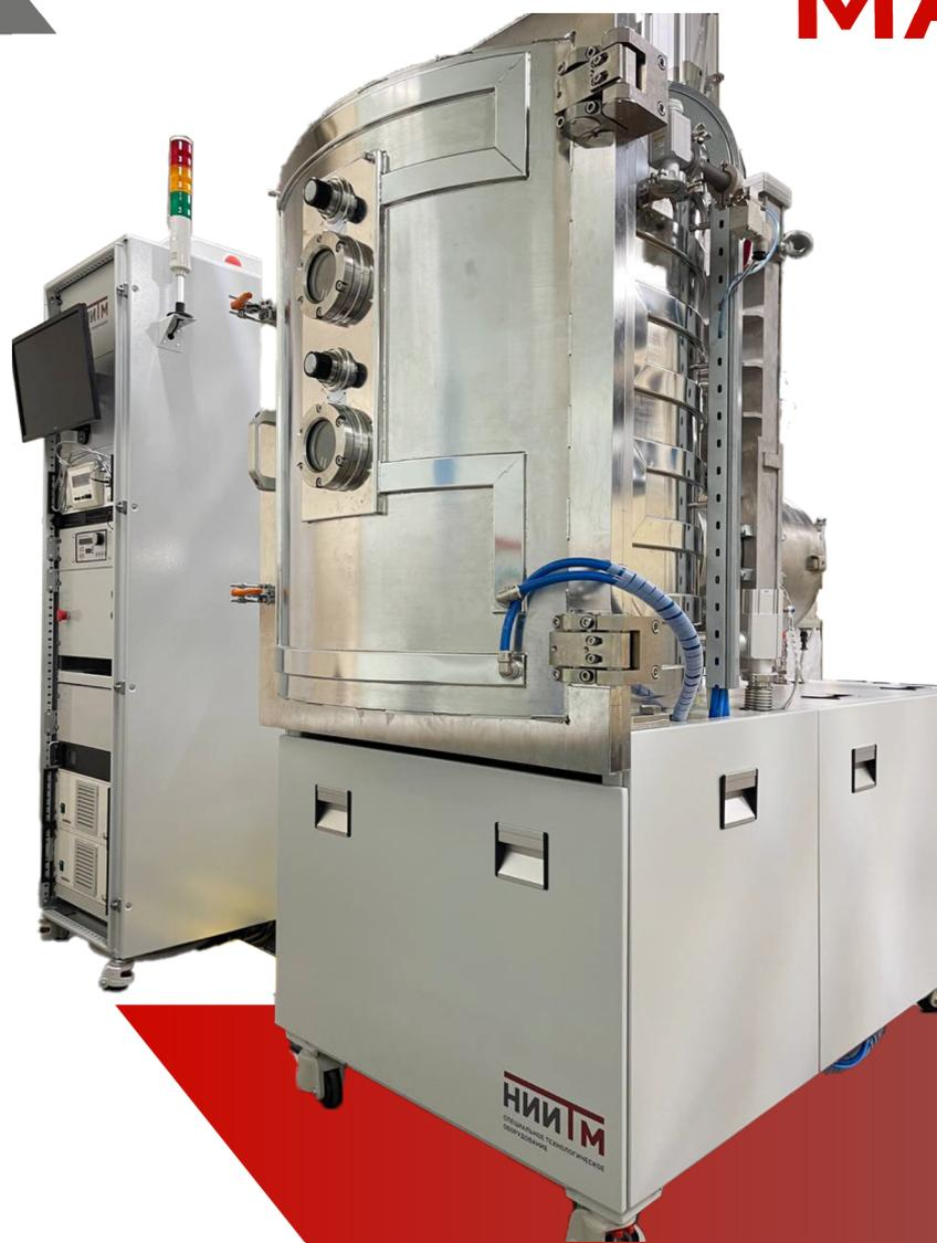
Оборудование для нанесения многокомпонентных и многослойных металлических или диэлектрических тонких пленок на подложки и пластины методом магнетронного распыления или электронно-лучевого испарения.
