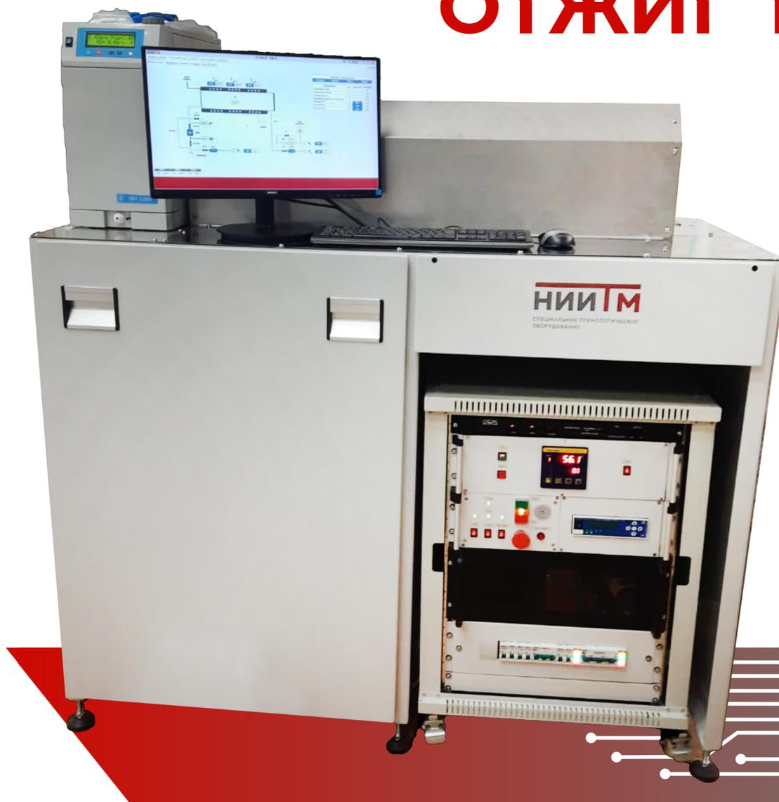
Группа горизонтальных диффузионных печей предназначена для автоматизированной термической обработки полупроводниковых пластин, керамических подложек и материалов при нормальном и пониженном давлении.
