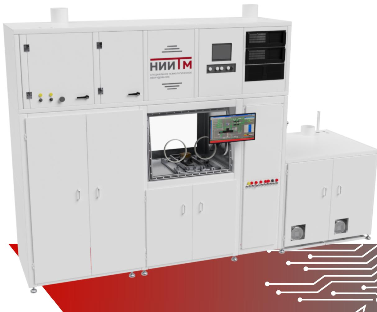
Серия установок для газофазного осаждения из металлоорганических соединений для эпитаксиального роста гетероструктур, газофазного осаждения моно- и поликристаллических слоев кремния, осаждения сверхтолстых поликристаллических слоев кремния из твердого источника, а также ферро-гранатовых и других структур из жидкой фазы.
