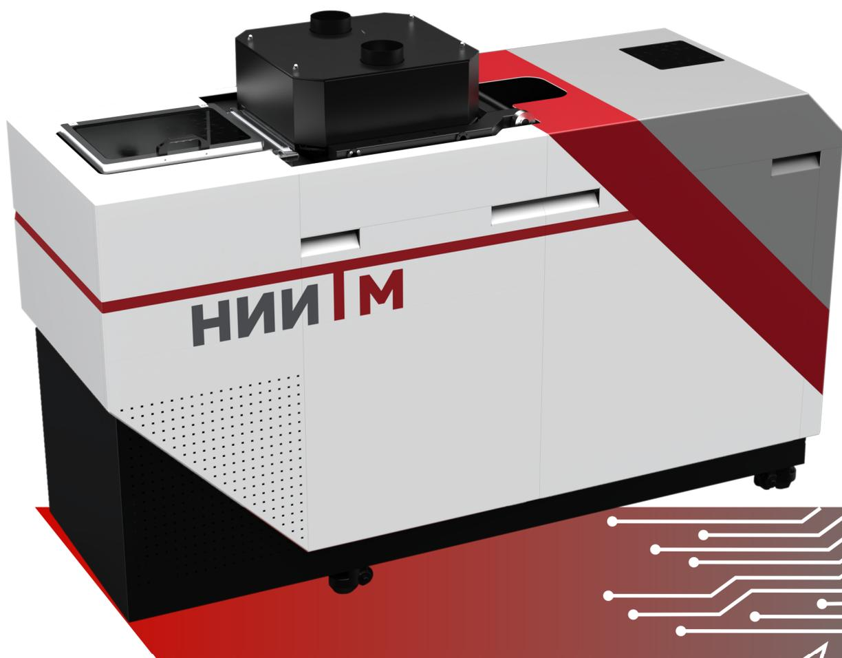
Установка быстрого термического отжига для обработки полупроводниковых пластин в инертной среде с целью отжига дефектов и активации примесей после ионного легирования.
