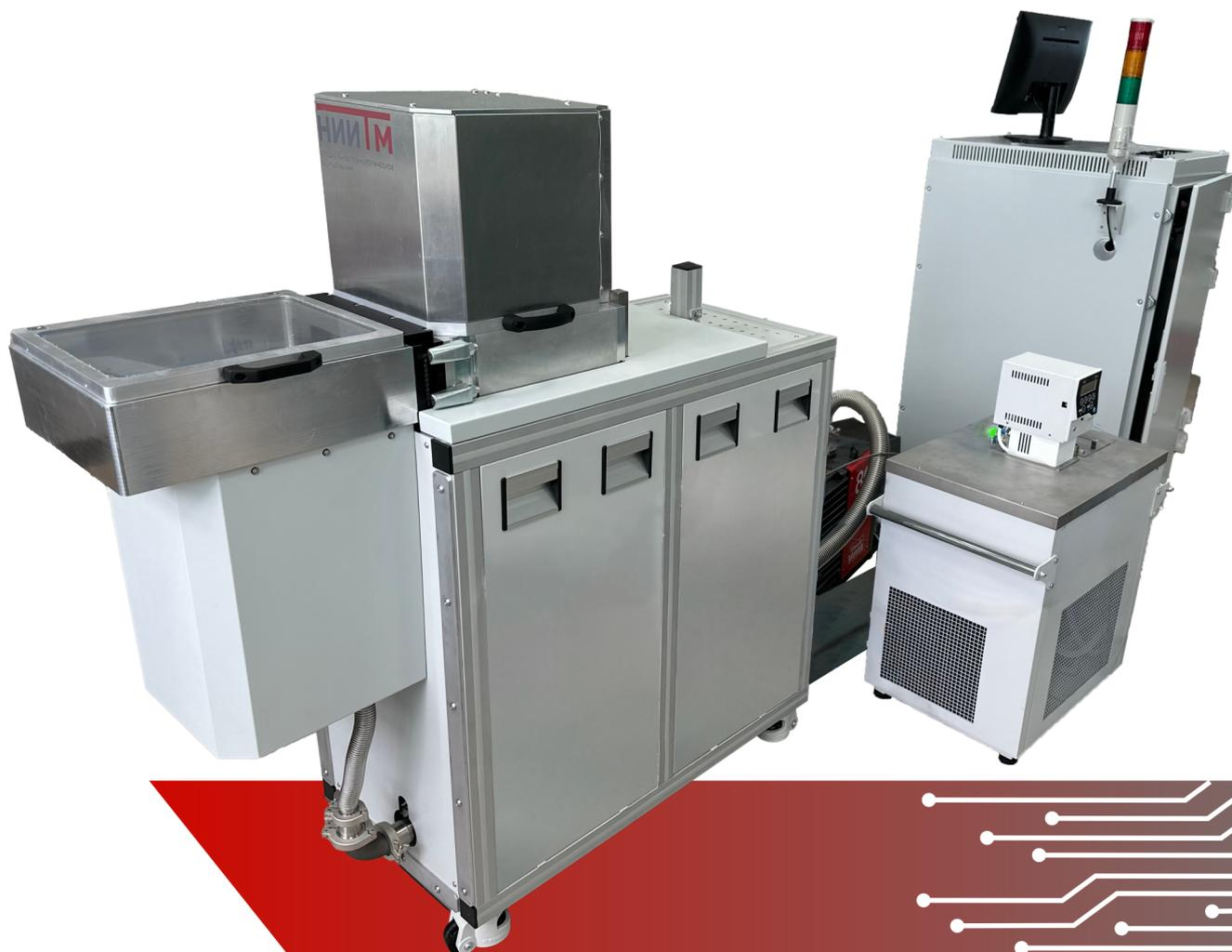
Серия установок плазмохимического травления диэлектрических слоев и полупроводниковых материалов методом реактивно-ионного травления, алюминиевой металлизации в хлорсодержащей плазме, а также тонких металлических слоев и материалов группы АЗВ5.
