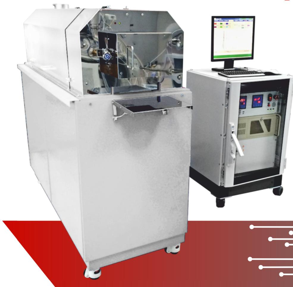
Группа горизонтальных диффузионных печей для автоматизированной высокотемпературной обработки полупроводниковых пластин, керамических подложек и материалов при пониженном или нормальном давлении для осаждения слоев нитрида кремния, оксида кремния, легированного и нелегированного поликремния.
